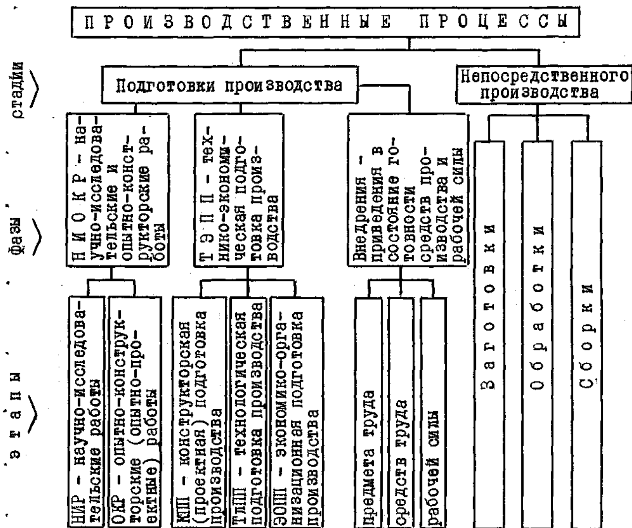
Рис. 3. Классификация производственных процессов по стадиям, фазам и этапам
